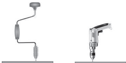
Furação de placas cimentícias com broca manual ou furadeira.
