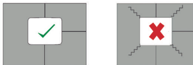
Detalhe de canto arredondado x detalhe de canto vivo.
